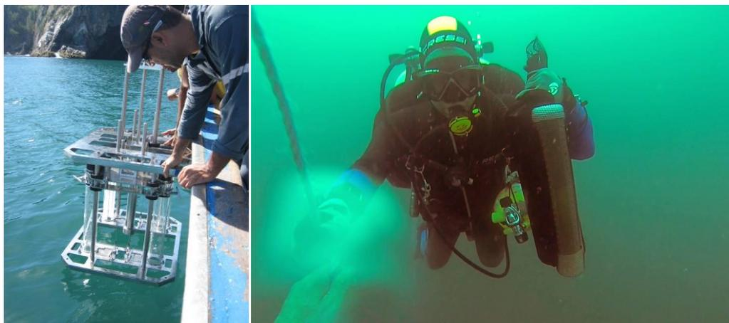
Figura 10 (esquerda) Multicorer utilizado para coleta de sedimentos e água intersticial e (direita) utilização de mergulho como apoio da operação de coleta de sedimentos.
