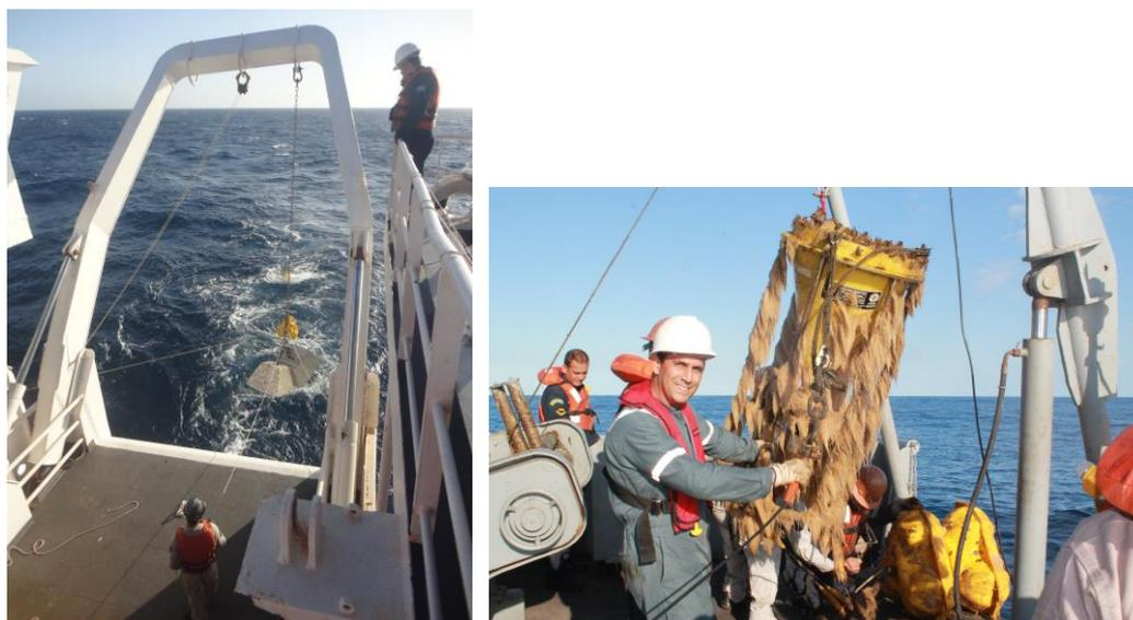
Figura 2 (esquerda) Lançamento da poita dupla do Fundeio 07 e (direita) recuperação do mesmo Fundeio 07 cerca de 9 meses depois.
