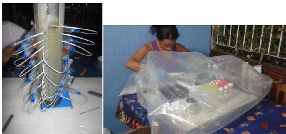
Figura 12 (esquerda) aplicação dos rizomas para amostragem de água intersticial e (direita) fixação das amostras dentro do Glovebag.
