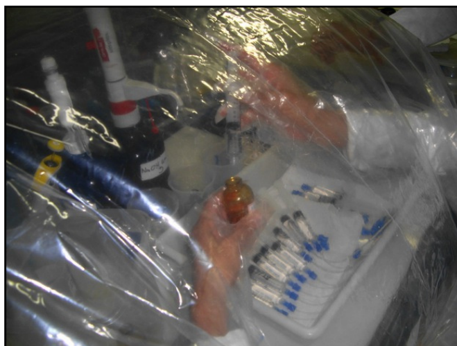
Foto 8 Imagem da manipulação de fixação de amostras de água intersticial a bordo da embarcação durante a coleta na plataforma continental de Cabo Frio.
