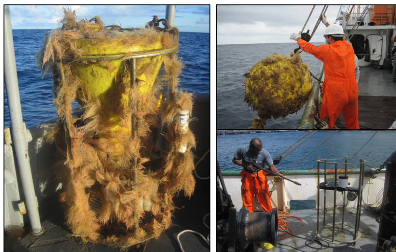
Foto 15 Imagens que ilustram o grau de incrustação sofrido pelos equipamentos do fundeio oceanográfico (armadilha de sedimentação e boia superficial) e a limpeza necessária a cada manobra de recuperação e reinstalação.
