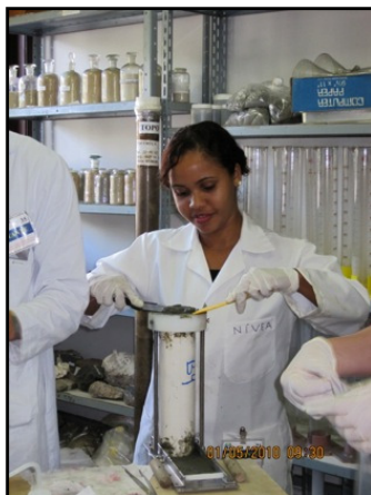
Foto 10 Imagem ilustrando a extrusão de sedimentos dos box-cores coletados na plataforma continental de Cabo Frio.
