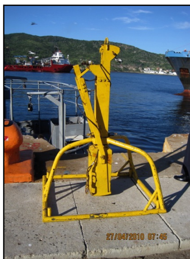
Foto 4 Coletor box-corer utilizado durante a coleta de sedimentos na plataforma continental de Cabo Frio.
