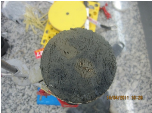
Foto 14 Detalhe da oxidação de sedimentos causada pela bioturbação.
