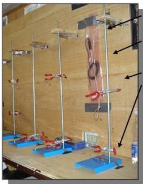
Foto 5 Base de madeira fixada no barco, para prender as hastes metálicas usadas para segurar os testemunhos durante a retirada de água intersticial.
