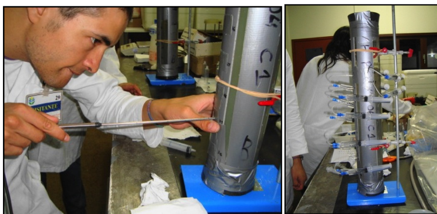
Foto 9 (Esquerda) imagem mostrando a introdução da sonda para medição de pH e Eh nos sedimentos, para posterior retirada de água intersticial através de rizomas e (direita) Imagem do procedimento de retirada de água intersticial de testemunhos box-cores através de rizomas.
