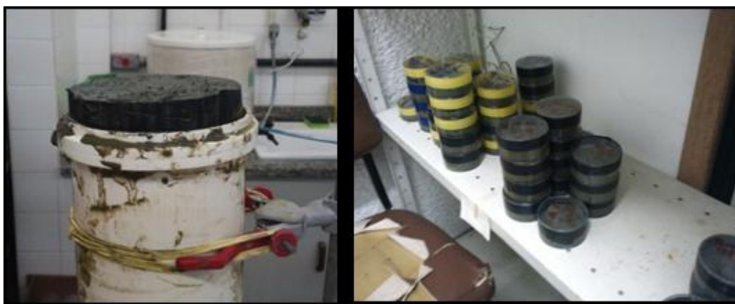
Foto 12 Imagens da extrusão dos sedimentos (esquerda) e do repouso para equilíbrio secular (direita).
