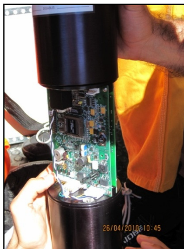
Foto 11 Imagem mostrando procedimento para programação teste do liberador acústico a bordo do Paq. Oc. DIADORIM/Marinha do Brasil.
