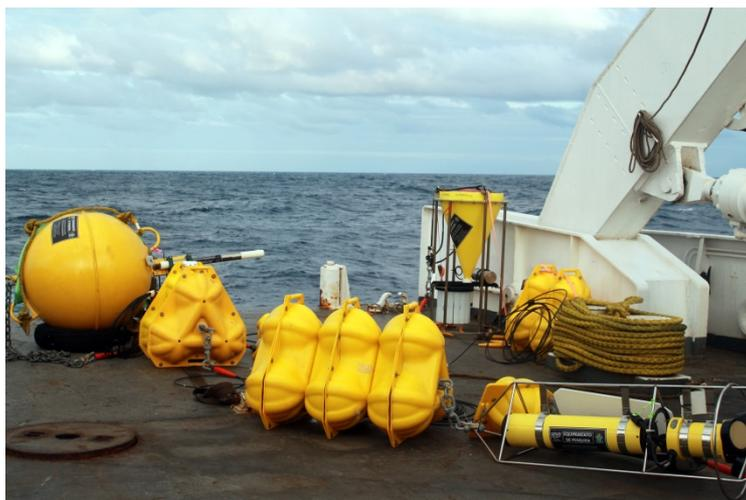
Figura 5 Equipamentos do fundeio a bordo do NHO Amorim do Valle, prontos para lançamento na área A.
