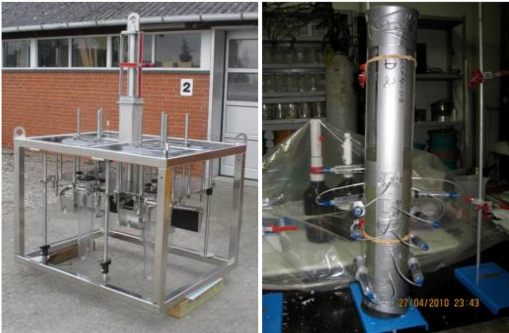
Figura 10 (esquerda) Multicorer que será utilizado para coleta de sedimentos e água intersticial e (direita) aplicação dos rizomas para amostragem de água intersticial, mesmo procedimento utilizado na Fase I do Projeto Ressurgência.
