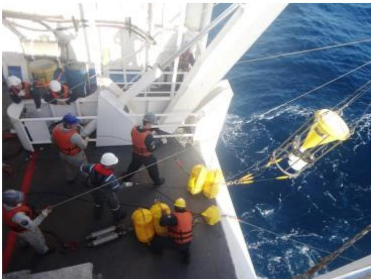
**Figura 4** Detalhe do lançamento da armadilha de sedimentação do fundeio F-150#07 a bordo do NHO Antares.
