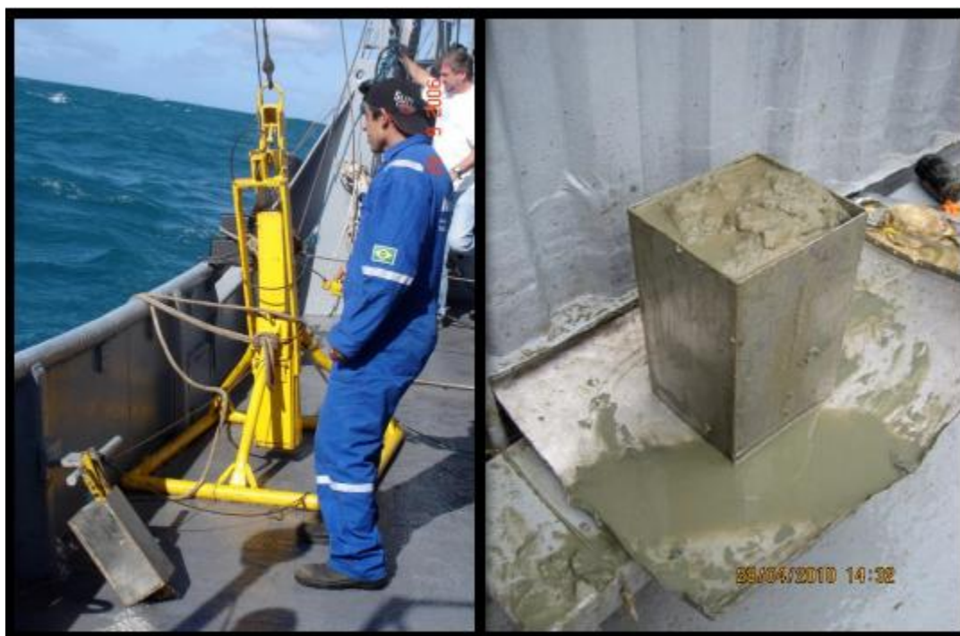
Figura 9- À esquerda – imagem do amostrador box-corer utilizado na coleta dos testemunhos em 2010, a bordo da embarcação Av.Pq.Oc. Diadorim. À direita – imagem de um box-core coletado.
